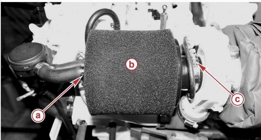
Luftfiltergehäuse am Motor
